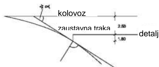
Slika 5.2.26: Uvijanje paralelnih i razdelnih rampi
