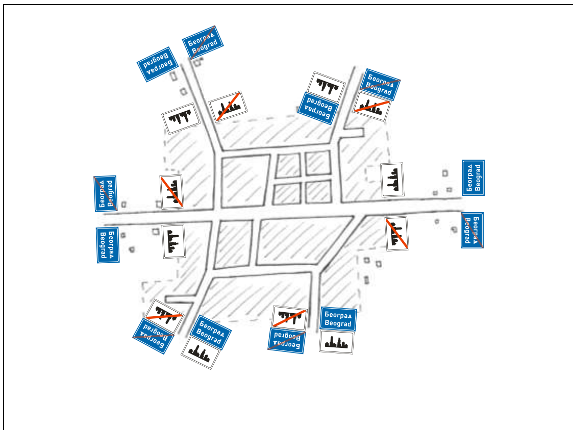
Slika 6.1.26: Način postavljanja znakova III-23, III-23.1, III-24 i III-24.1
