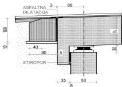
Slika 9.9.4: Oslanjanje RK i krajnjeg stuba preko ležišta
