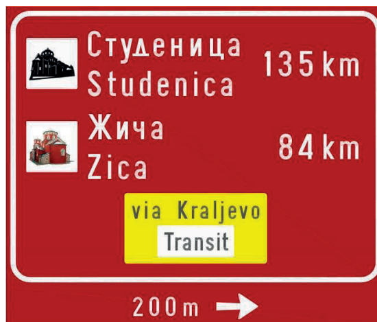
Слика 9-1-27 Пример знака за означавање више туристичких одређишта који се поставља на улазу у насеље у ком се врши вођење саобраћаја по транзитном правцу. Знак се поставља испред раскрснице на којој се скретањем десно наставља кретање транзитним правцем, као и кретање ка туристичком одређишту
