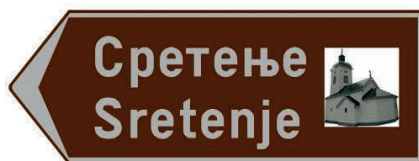
Слика 4-54 Знак туристички путоказ израђен у складу са стандардом SRPS U.S2.600 (314). Према стандарду није било могуће предвидети фотографски приказ на овим знаковима
