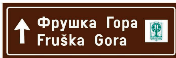
Слика 4-42 Знак туристичка путоказна табла израђен у складу са стандардом SRPS U.S2.600 (314). Према стандарду није било могуће предвидети фотографски приказ на овим знаковима
