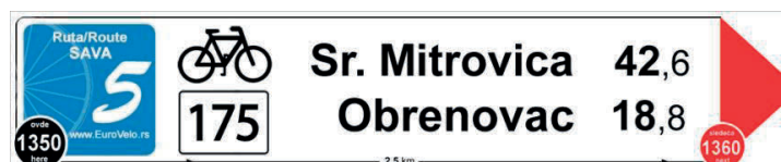
Слика 9-9-11 Знак „бицикlistички путоказ“ који се поставља на главној траси локалне бицикlistичке руте
