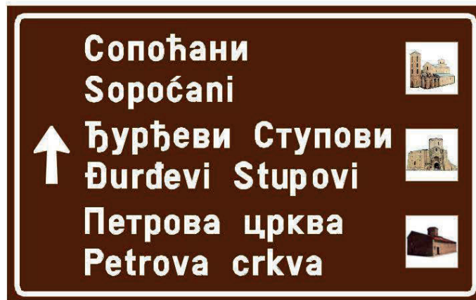
Слика 4-46 Знак туристичка информациона табла израђен у складу са важећим стандардом SRPS U.S2.314. Примена оваквог знака, према важећим прописима није била могућа
