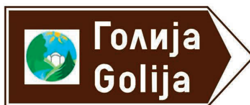
Слика 4-49 Знак туристички стреласта путоказ израђен у складу са стандардом SRPS U.S2.600 (314). Према стандарду није било могуће предвидети фотографски приказ на овим знаковима
