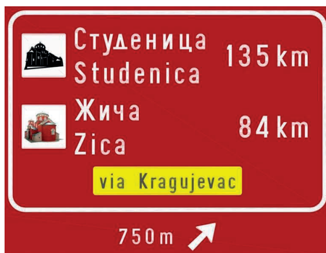
Слика 9-1-28 Пример знака за означавање више туристичких одређишта који се поставља испред искључења са аутопута или мотопута
