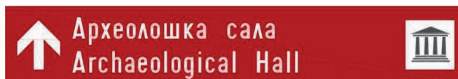
Слика 4-76 Знак туристичка путоказна табла израђен у складу са предлогом стандарда SRPS U.S2.600., на основу примене и модификације стандарда SRPS U.S2.341.
