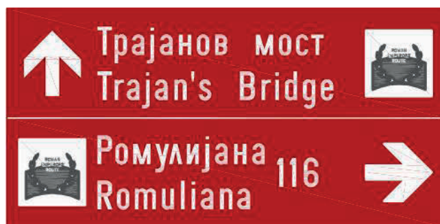
Слика 4-16 Знакови туристичка путоказна табла на заједничком носачу израђени и поређани у складу са предлогом стандарда SRPS U.S2.600, чиме је уклоњен један од основних недостатака стриктне примене наведеног стандарда и правилника о саобраћајној сигнализацији
