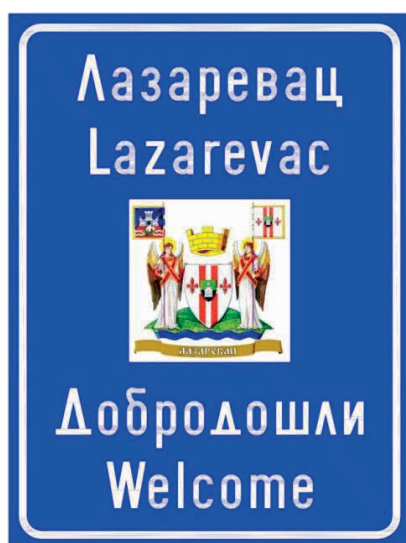
Слика 4-110 Знак туристичка табла за израз добродошлице израђена у складу са предлогом стандарда SRPS U.S2.600 чиме је омогућена рационализације димензије знака
