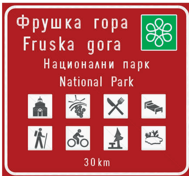
Слика 9-1-5 Пример знака за означавање једног туристичког одређишта, када се поставља испред раскрснице на којој се кретањем право иде према туристичком одређишту или на локацији на путу који води директно до туристичког одређишта
