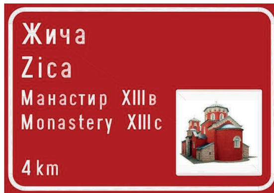
Слика 9-1-1 Пример знака за означавање једног туристичког одређишта, када се поставља испред раскрснице на којој се кретањем право иде према туристичком одређишту или на локацији на путу који води директно до туристичког одређишта
