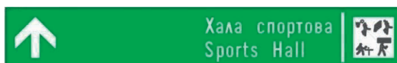
Слика 4-63 Знак туристичка путоказна табла израђен у складу са предлогом стандарда SRPS U.S2.600., на основу примене и модификације стандарда SRPS U.S2.341.
