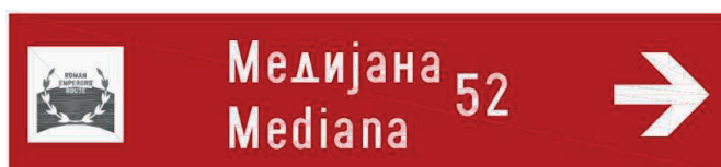
Слика 4-14 Знак туристичка путоказна табла израђен у складу са предлогом стандарда SRPS U.S2.600, а на основу примене модификованог стандарда SRPS U.S2.341 који је коришћен за упућивање дуж туристичке руте на значајнијим раскрсницама
