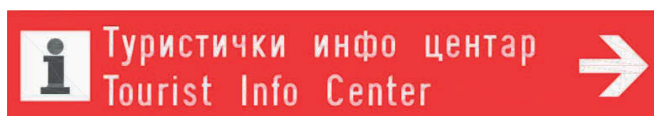
Слика 4-75 Знак туристичка путоказна табла израђен у складу са предлогом стандарда SRPS U.S2.600., на основу примене и модификације стандарда SRPS U.S2.341.
