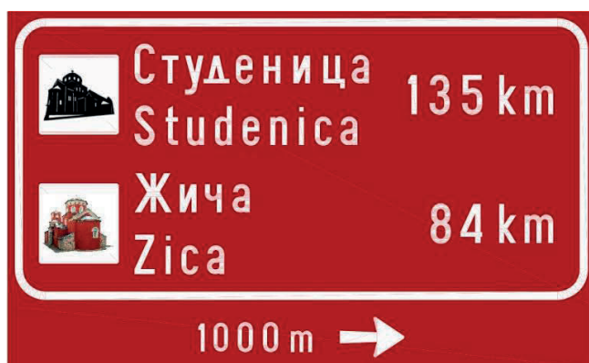
Слика 9-1-14 Пример знака за означавање више туристичких одређишта испред једне раскрснице, који се користи у случају када се на раскрсници кретање ка различитим одређиштима врши у истом смеру (у овом случају је на раскрсници потребно скренути десно да би се дошло до свих одређишта која су наведена на знаку)
