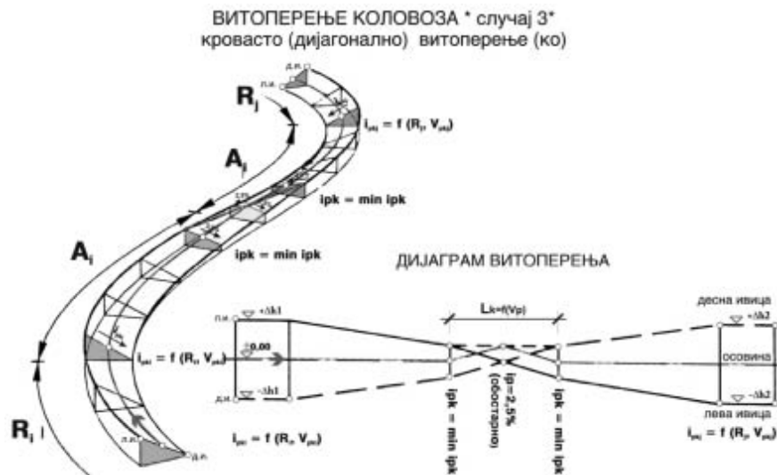
Слика 8-05: Двостепена промена попречног профила са кровастим (дијагоналним) витоперењем.
