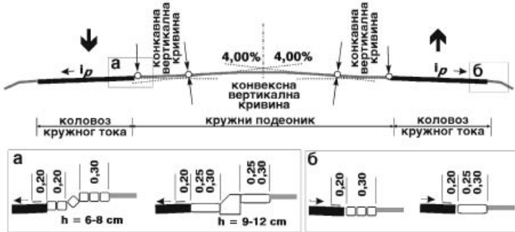
Слика 4-21: Обликовање ивица кружног коловоза .
