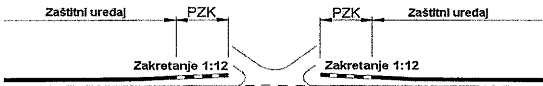
Слика 12а: Прекид заштитних уређаја са почетном и завршном конструкцијом и са закретањем
