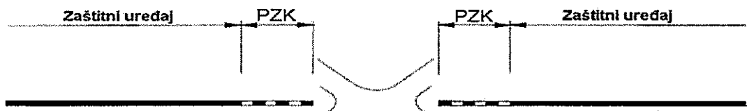
Слика 12б: Прекид заштитних уређаја са почетном и завршном конструкцијом у линији заштитног уређаја
