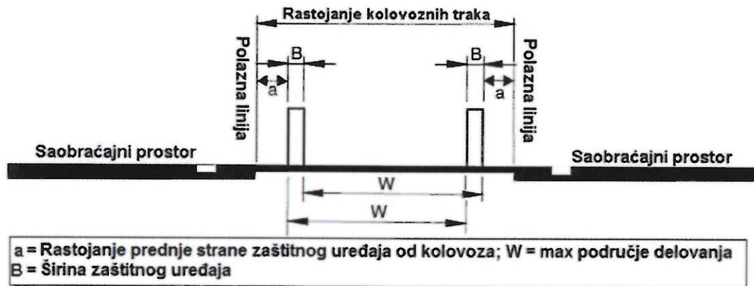
Слика 17в: Једнострани заштитни уређај са одвојеним деловањем постављен на обе ивице
