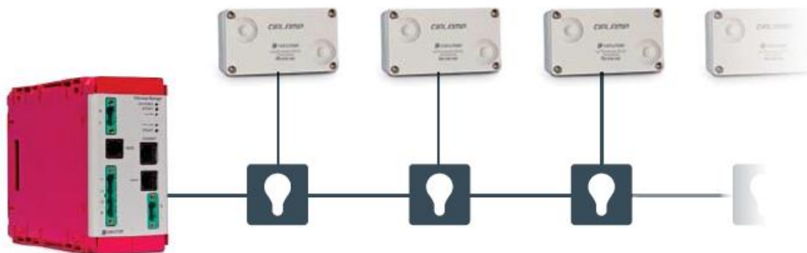
Слика 6.15. Основни елементи „CirLamp“ система телеменаџмента осветљењем
