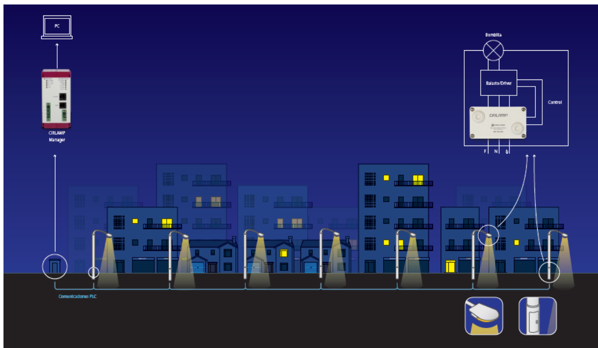
Слика 6.14. Принципијелна шема „CirLamp“ система телеменаџмента осветљењем
