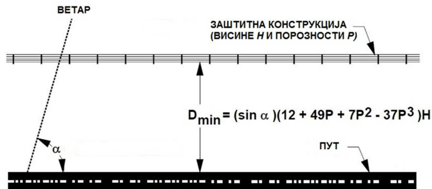
Слика 7.12 Заштитна конструкција паралелна са осовином пута
