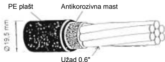
Slika 9.10.28 Kabl od jednog užeta (monokabl)
