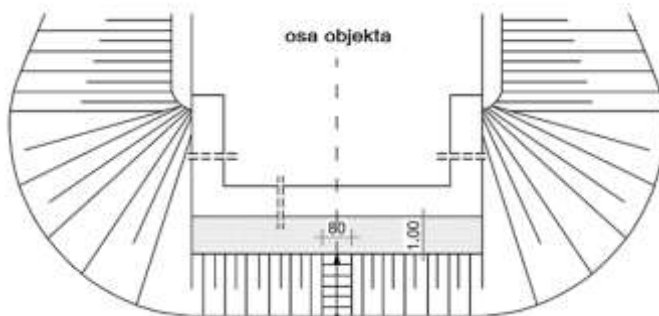
Slika 9.12.11.3 Položaj stepenica za pristup do ležišta sa puta ispod mosta
