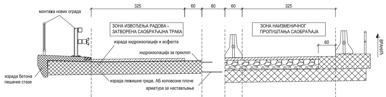
Након рушења постојеће коловозне АБ плоче на мосту, следи чишћење (издувавање) површине бетона, бушење рупа Ø25мм, уградња анкера RØ14mm за повезивање бетона постојећих стубова и нових лежишних греда као и анкера за везу крила и додатног бетона и заливање уграђених анкера експанзивним малтерима.
