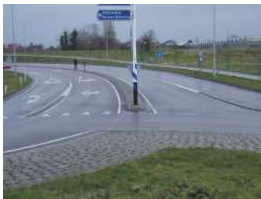
Slika 5.3.61: Razdelno ostrvo u obliku suze u turbo kružnoj raskrsnici bez prisustva nemotorizovanih učesnika u saobraćaju.
