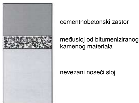
Slika 8.2.7.1: Karakterističan sastav cementno-betonskih kolovoznih konstrukcija
