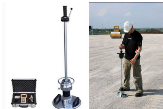
Slika 4 : Deflektometar male težine (Low Drop Weight Tester – LDWT)
