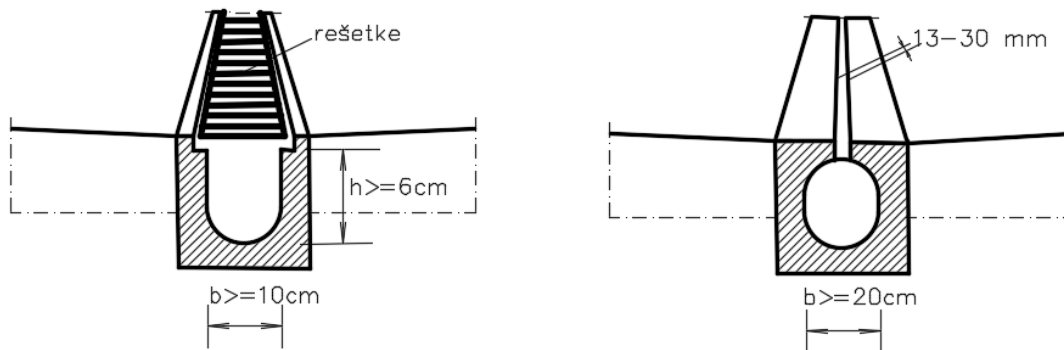
Slika 19 Primeri kanala za linijsko dovodnjavanje sa rešetkom (levo) i sa otvorom (desno)
