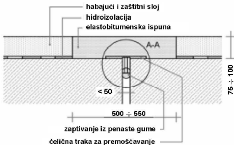
Slika 14 Detalj asfaltne dilatacije
