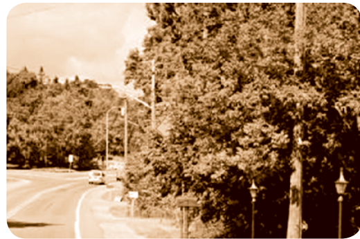
Фотографија 16. Заклоњен знак за заустављање
