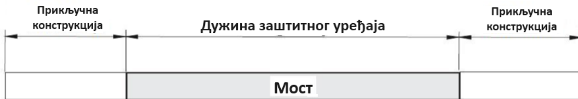
Слика 22б: Заштитни уређај са прикључном конструкцијом на мосту
