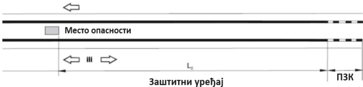
Слика 20: Заштитни уређаји са једностраним деловањем са почетном и завршном конструкцијом на почетку средњих или бочних разделних појасева
