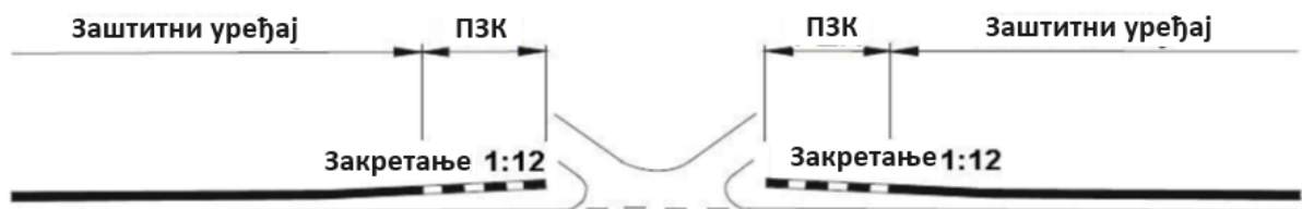
Слика 14а: Прекид заштитних уређаја са почетном и завршном конструкцијом и са закретањем
