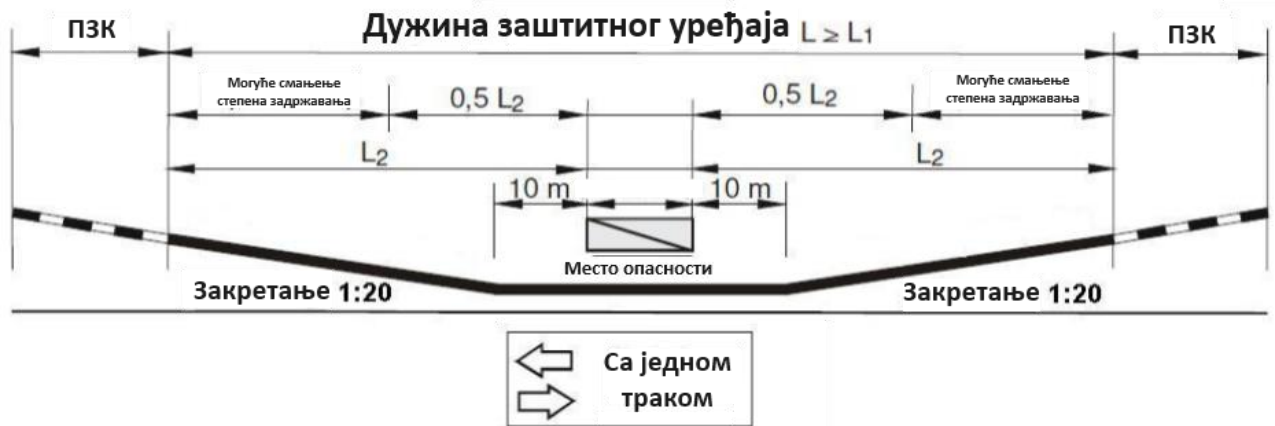
Слика 13а: Минималне дужине заштитних уређаја при закретању испред места опасности (пут са једном коловозном траком)
