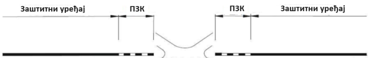
Слика 14б: Прекид заштитних уређаја са почетном и завршном конструкцијом у линији заштитног уређаја
